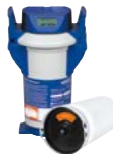
OS1632 Filtre Purity STEAM 450 avec système de compteur MDU-litre inclus Capacité 3680 l à 10°dH avec bypass en pos.1 Temp de travail. 4°C à 30°C presse max. 6,9 bar Connexions de la tête d'entrée / sortie G1 "- G3 / 4" faible. Ø249x408h
