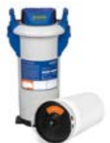
OS1634 Filtre Purity STEAM 1200 avec système de compteur MDU-litre inclus Capacité 10800 l à 10 ° dH avec bypass en pos.1 Temp de travail. 4 ° C à 30 ° C presse max. 6,9 bar Connexions de la tête d'entrée / sortie G1 "- G3 / 4" faible. Ø249x550h
