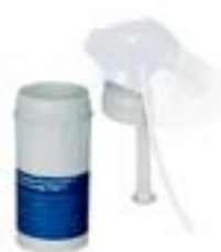
OS1892 Cartouche de service Purity C pour le nettoyage, la désinfection et le détartrage des équipements directement connectés. ▶ Ø 125 mm - H 233 mm ▶ Capacité maximum de la cartouche 0.5 L ▶ Pression de service 0.5-8.6 bar ▶ Température d'arrivée de l'eau 4-30 ° C ▶ La cartouche n'inclut pas la tête OS1638
