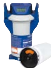
OS1632 Filtre VAPEUR Purity 450 avec MDU - système de compteur de litres inclus Capacité 3,680 L à 10° dH avec by-pass à pos.1 ▶ Temp. de travail 4°C-30°C ▶ Pression max. 6.9 bar ▶ Connexion tête d'entrée/sortie G1" - G3/4" ▶ Dim. Ø249x408h
