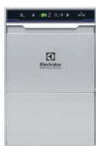
1 Un **Lave-vaisselle Wine-Line** (casier de 500x500 mm) est capable de réduire considérablement les dommages normalement causés aux verres tout en évitant l'essuyage manuel, grâce à une température de lavage plus basse de 50 à 55°C, un démarrage progressif et une température de rinçage continue à 84°C assurant un assainissement et moins de bris de verre.
